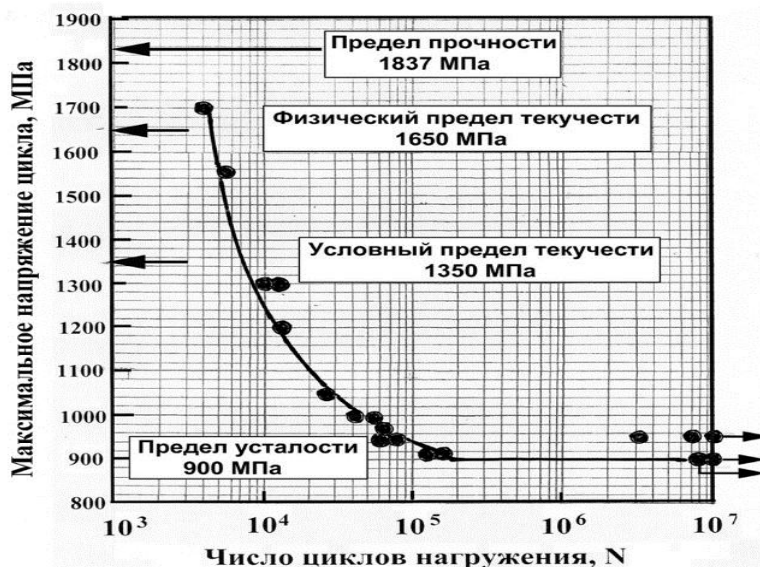
Рис. 5.2. Кривая усталости образцов из стали ВС9-Ш
