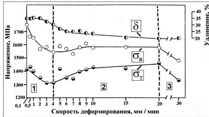
Рис. 4.5. Изменение механических свойств на образцах серии 2 стали ВНС9-III в зависимости от скорости деформации.
